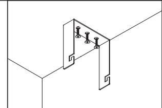
Esempio di fissaggio a soffitto con scatola laterale
