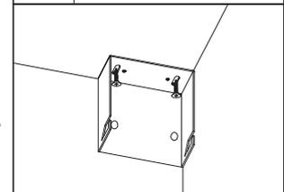
Esempio di fissaggio a parete con scatola laterale
