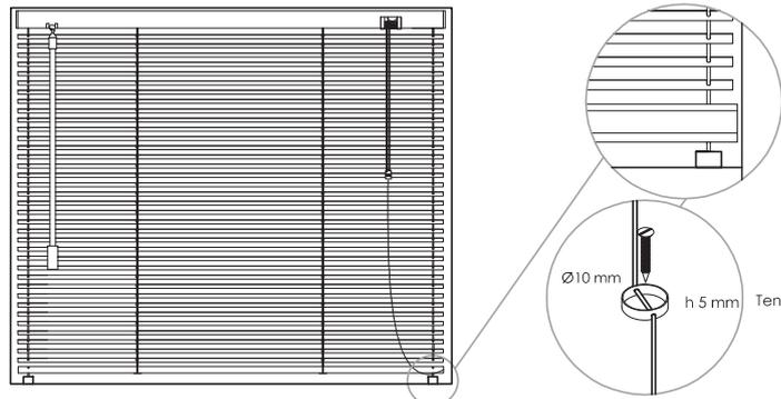
$\varnothing 10 \text{ mm}$  h 5 mm Tendicavo/Piano
