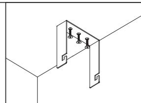
Esempio di fissaggio a soffitto con scatola laterale
